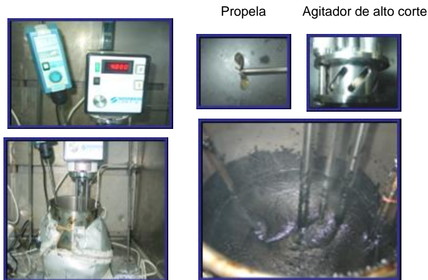
Figura 1. Equipo utilizado para la preparación de las mezclas Asfalto-Caucho
